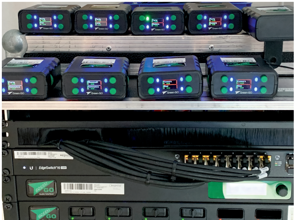
Das Testsetup bestehend aus 4 × BPX, 4 × WBPX, 1 × InterfaceX und dem Funk-Interface
