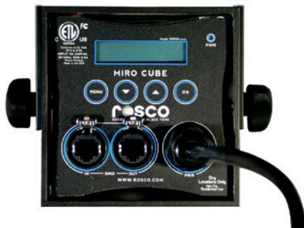
Miro Cube™ ARC Version mit DMX Ein- und Ausgang über Neutrik Ethercon und festem Netzanschluss.
