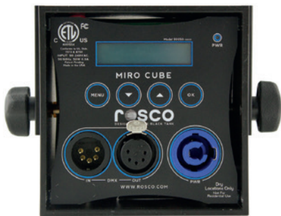
Rückansicht des Miro Cube™ WNC: DMX Ein- und Ausgang über XLR 5-pol Steckkontakte.
