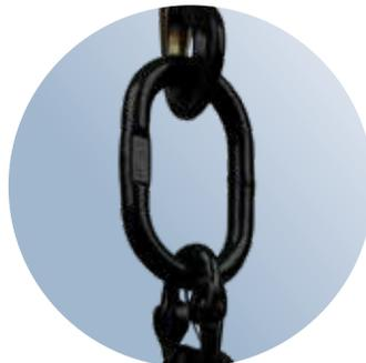
fiRSTstage Kettengehänge Güteklasse 8, Ketten-Nenndicke 6 mm, Einzelstrang, Tragfähigkeit Last über Personen 560 kg  $\leq 7^\circ$  gemäß DGUV Vorschrift 17/18 (bisher BGV C1)
