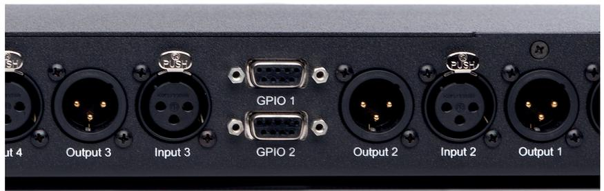
Jeder Green-GO Engine stehen jeweils zwei GPI-Eingänge und zwei GPO-Ausgänge zur Verfügung, welche einer Integration erweiterten Zugriff auf alle Funktionen der Green-GO Engine ermöglichen.
